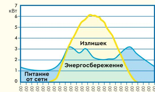
График энергопотребления типовой фермы с потреблением электроэнергии 20'000 кВт·ч/год и солнечной электростанцией на 7 кВт
